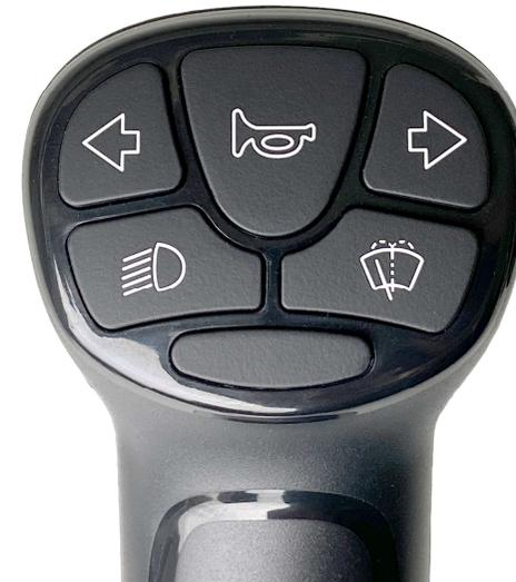
SmartSteer ist mit beleuchteten Tasten ausgestattet. Die Symbole leuchten auf, wenn die ovale Taste ohne Symbol gedrückt wird. Nach 10 Sekunden wird die Beleuchtung langsam gedimmt.
